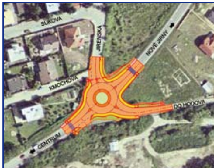
Okružní křižovatka na silnici II/101 - výřez z výkresu přehledné situace poskytl CityPlan, s.r.o., Praha
