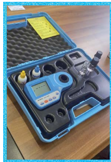
Přenosný fotometr na měření volného chloru ve vodě
